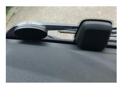
b) Install adhesive antenna LTE (A 005 820 4675).
